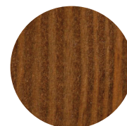
Parti in legno tinto noce . Procedimento di verniciatura con triplo trattamento.
